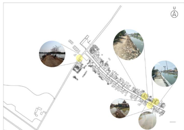
Gambar 5. Kondisi Infrastruktur Jalan Kondisi jalan pada umumnya dibuat dari tanah urug, tanah urug sangat mudah berubah jika keadaan beban yang ditopang berat. Ada beberapa kondisi
