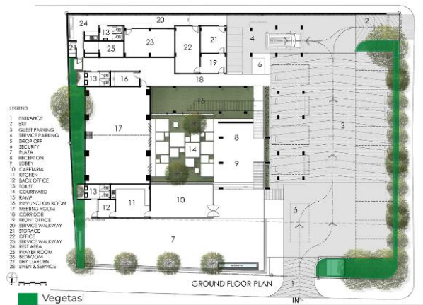
Gambar 10. Persebaran Pemasangan Vegetasi pada Tapak
